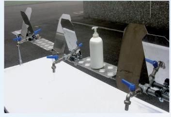
Il lavandino campale smontabile è composto da una struttura portante realizzata in tubo di acciaio zincato completo di agganci con perni a molla, la stessa è dotata di impianto idrico costituito da un tubo di distribuzione acqua e sei rubinetti ( solo acqua fredda o da fonte miscelata )
